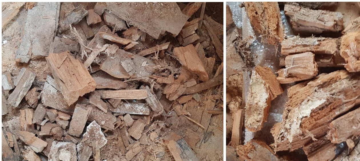
Kostičkový rozpad a rhizomorfy v odtěženém trámu podlahy 3.NP
