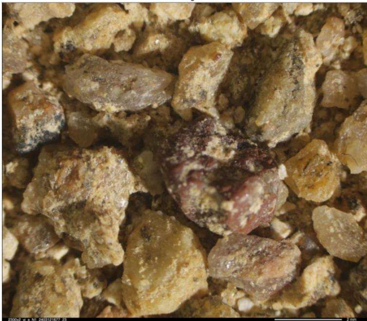
Obr. 8: Mikrofotografie promytého kameniva
