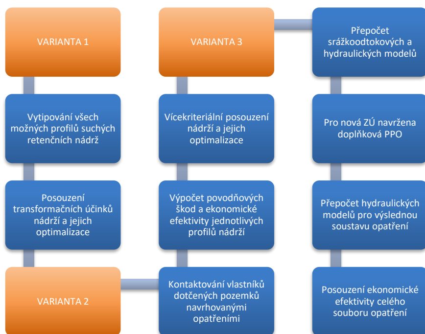
Obr. 1 – Schéma postupu prací při optimalizaci návrhů opatření
