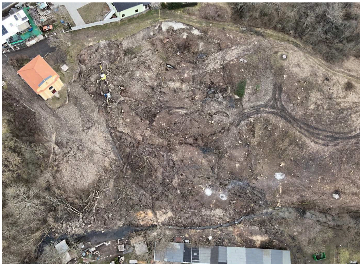
Pohled na zúžení koryta potoka a celkový rozsah sesuvu únor 2024
