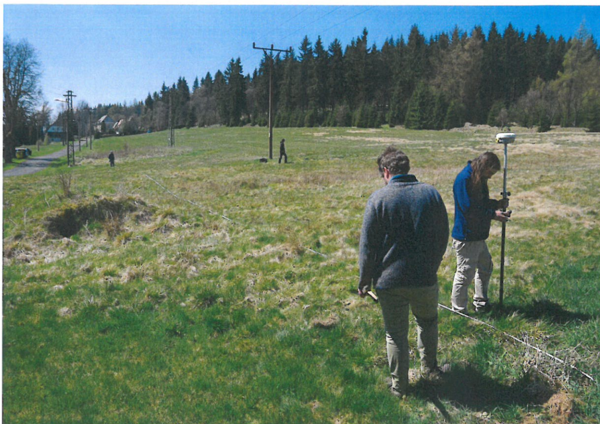
Geodetické měření přístrojem využívajícím globální navigační satelitní systém.
